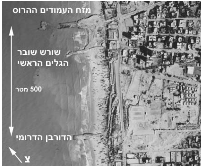
איור 3: מזוח העמודים שהוקם בשנת 1994 כהמשך לדורבן הצפוני, ונהרס בסערת גלים בנובמבר אותה שנה. לאחר מכן החלה הקמת שובר הגלים הראשי של נמל הדייג (תצ"א אוקטובר 1996).
